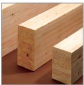
コンピューター制御による高精度プレカットで加工されるエンジニアリングウッド（JAS 構造用集成材）を採用。天然木材の長所をそのままに、反り、ねじれ、割れ、伸縮などの欠点を克服し、飛躍的な強度を実現。しかも安定した品質が構造計算を可能にし、大規模構造建築物をも可能にします。
